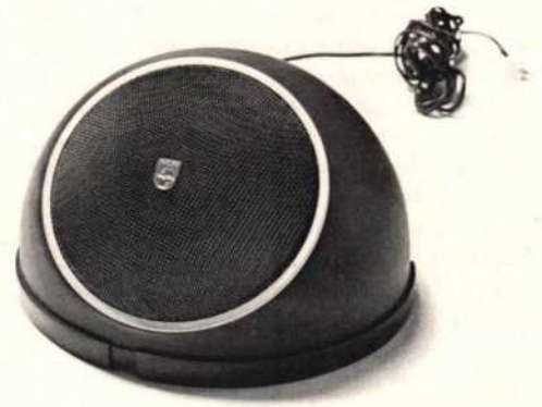
Afb. 3 Bredeband halfkogelluidspreker volgens het basreflexprincipe voor sinusvormig uitgangsvermogen tot 10 W.
