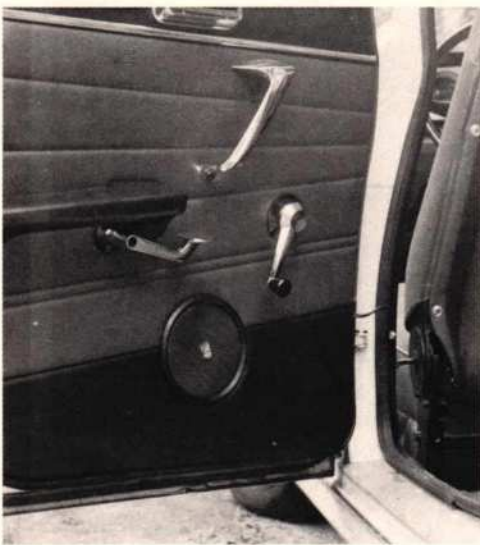
Afb. 2 Portierluidsprekers zijn gemakkelijk in te bouwen en ze vragen geen extra ruimte in de auto zelf. De afbeelding laat tevens zien, hoe de aansluitkabel kan worden geleid.
