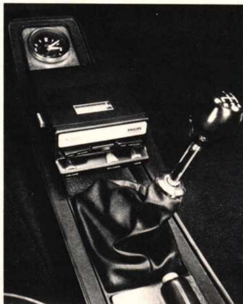
Afb. 1 Gemonteerd op de cardantunnel neemt de cassettespeler geen plaats weg en is daar gemakkelijk te bedienen.
