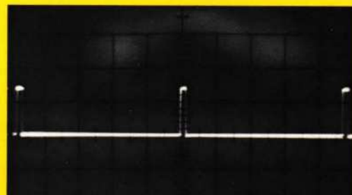
Afb. 2 Blokspanning waarbij t_1 < t_2 . De 100 kHz impulsen zijn aan de uitgang (punt 6) van de monostabiele multivibrator op het scherm van een oscilloscoop zichtbaar gemaakt. De impulsengte wordt door de extern geschakelde RC-combinatie bepaald.
